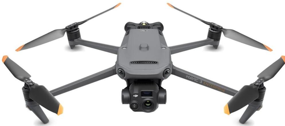
DJI Mavic 3T — промышленное решение нового поколения для тушения пожаров, поисково-спасательных операций, инспекции сооружений, ночных работ, проведения контртеррористических операций и т.д. Квадрокоптер имеет продолжительное время полёта — до 45 мин. Максимальное расстояние, на котором способна поддерживаться связь с дроном — 15 км.
