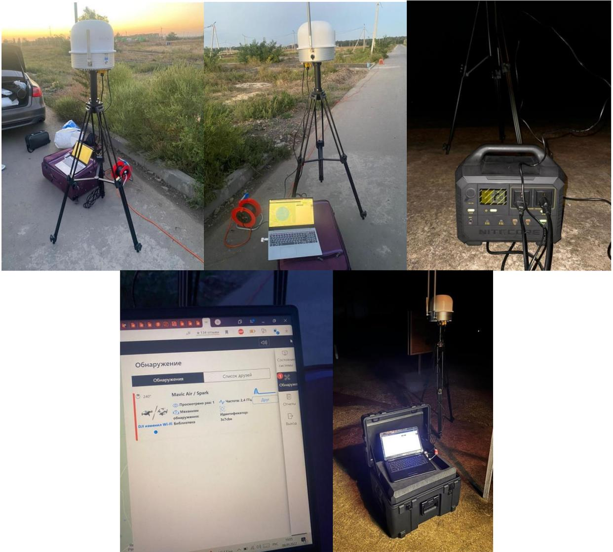
Skyscore - канадская система обнаружения дронов, видит все дроны, в отличие от аэроскопа DJI
