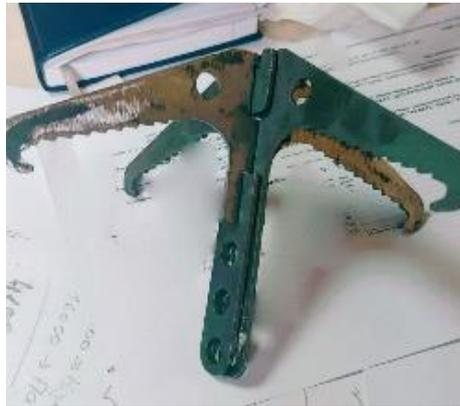
Кошка травяная (саперная) – это тактический инструмент, разработанный специально для снятия шнуров на растяжках и их дистанционной дитонации. Продуманная конструкция исключает притягивание лишних предметов. Используется различными воинскими подразделениями для безопасного преодоления местности.
