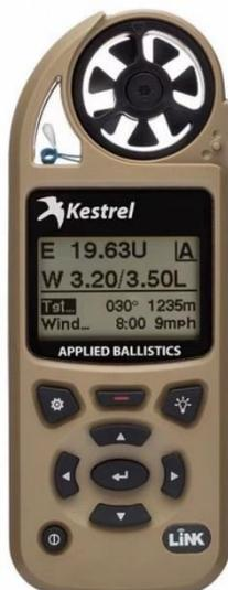
250 грамм Kestrel 5700 Elite выполняет все основные функции метеостанции для анализа погоды. Скорость ветра, давление, температура, влажность и многое другое. Но отличительной особенностью этой метеостанции является группа баллистических функций для точной калибровки оружия и ведения максимально аккуратной стрельбы на любых дистанциях (в том числе свыше 800 метров). Метеостанция помещается в ладони, практически ничего не весит и способна пережить самую неистовую ярость природы.
